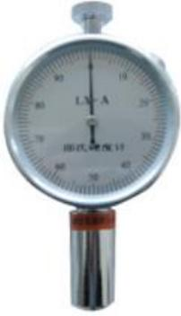
LX-A 邵氏 A 型硬度计适用于中低硬度塑料、皮革、各类橡胶、多元脂、蜡等硬度的测试仪器。本产品符合国家 GB/T531-1999 标准及其它相关标准的要求。
