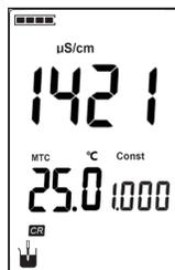
4. 根据常数  $k=C_s/C_t$  的关系，计算该电导电极的电极常数。然后进入常数设置，将计算的常数输入仪器内，按“确认”键保存设置。例如： $k=1408/1421=0.991$ ，即将常数设置为 0.991。
