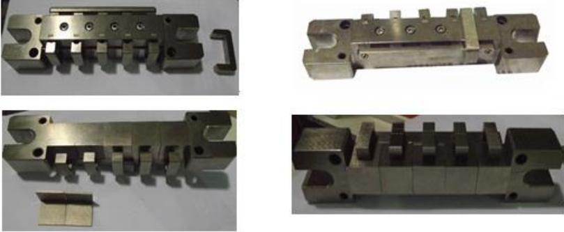
(7) 将夹紧板安装于夹紧座杆上，左右两个固定螺帽锁紧，将夹板固定于夹紧座上（见图6）
